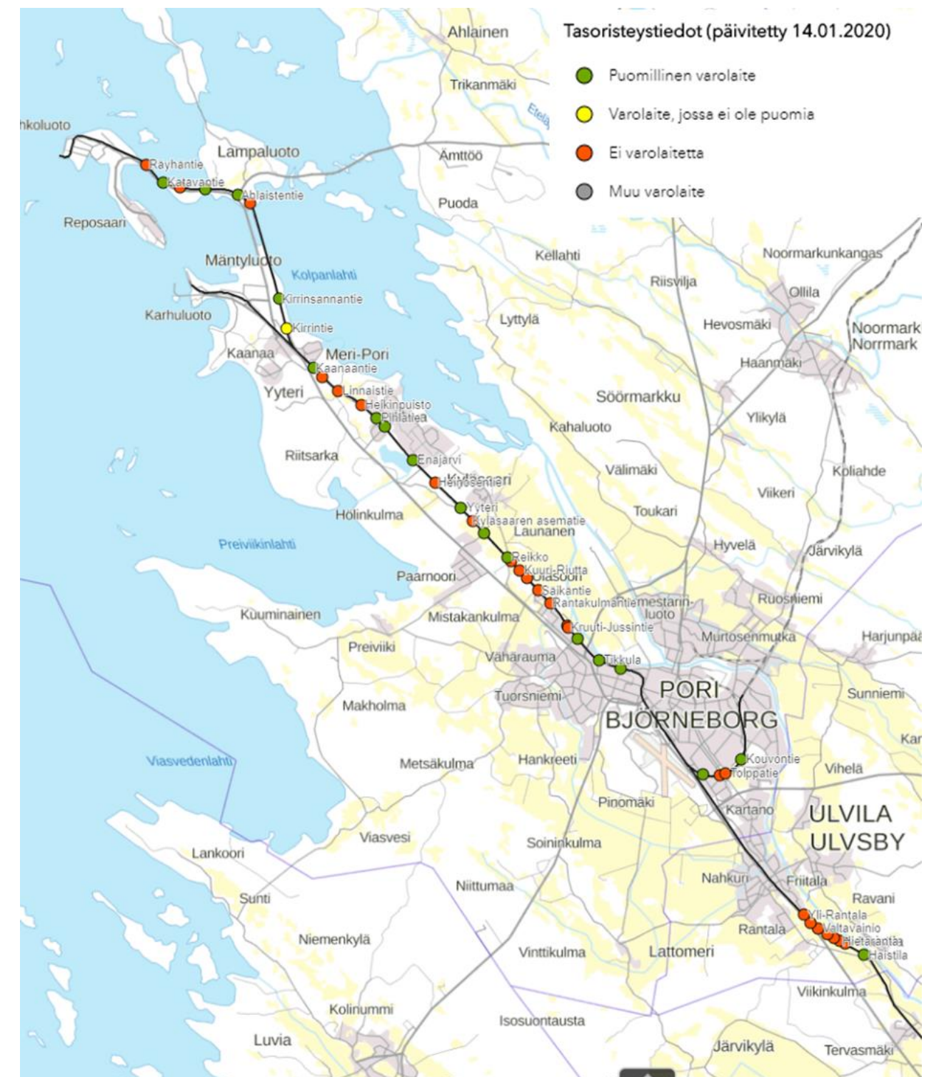
Kuva 6 Suunnittelualueen tasoristeykset ja niissä käytössä olevat turvalaitteet, tilanne 14.1.2020 (lähde: Väylän tasoristeyspalvelu).
