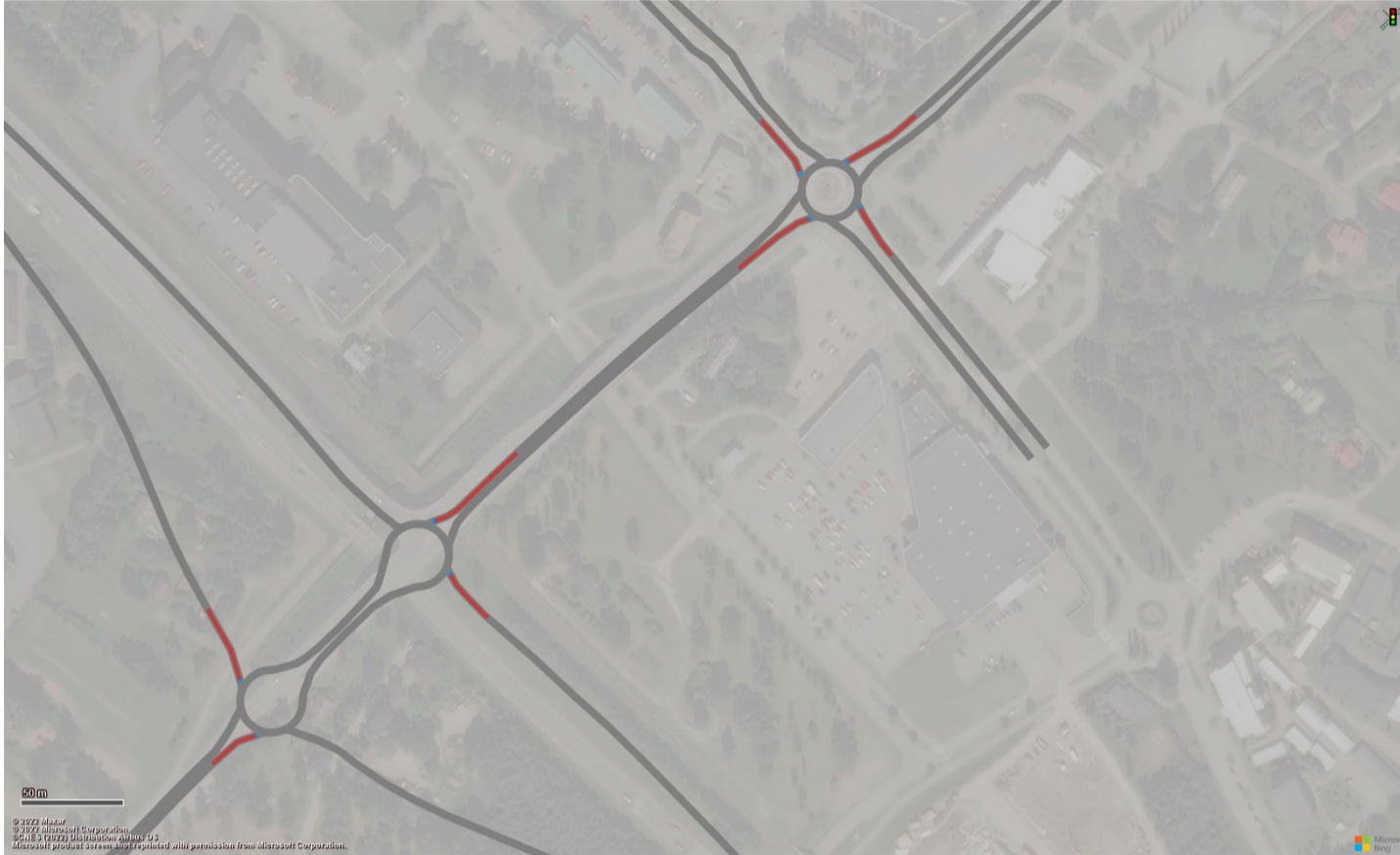
Kuva 16. Friitalan eritasoliittymän tasoliittymien ja Siltatien/Satakunnantien kiertoliittymän jonopituudet iltahuipputunnin aikana ennustetilanteessa. Punaisella maksimijonopituus, sinisellä keskimääräinen.
